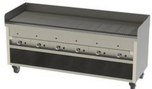
Согласно спецификации гриль настроен на природный газ. Резьба входного патрубка газопровода G1" дюйма слева (подключение к шлангу с регулятором давления для сжиженного газа не предоставляется возможным ). Для баллонного газа пропан предлагается индивидуальное исполнение.
